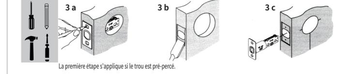
**Remarque:** Pour insérer le verrou, percez des trous aux dimensions indiquées sur le gabarit et appuyez sur le verrou jusqu'à ce qu'il affleure le bord de la porte.
